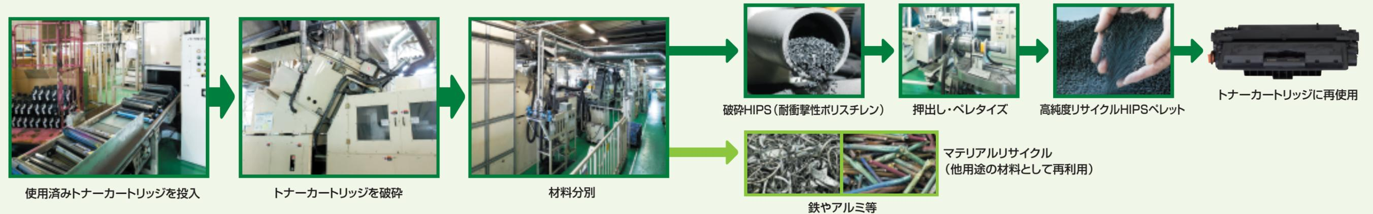
キヤノンはトナーカートリッジリサイクルの更なる環境対応を進めるため、材料リサイクルプラントを開発。2002年に日本のリサイクル拠点であるキヤノンエコロジーインダストリーに導入しました。部品再使用を行わないトナーカートリッジや部品再使用後の残部品をリサイクルしています。
