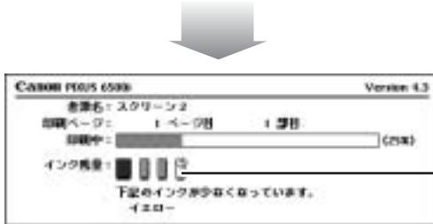
① が表示されているインクタンクは、インク残量が少なくなっています。新しいインクタンクをご用意ください。
