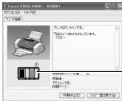
① が表示されているインクタンクは、インク残量が少なくなっています。新しいインクタンクをご用意ください。
