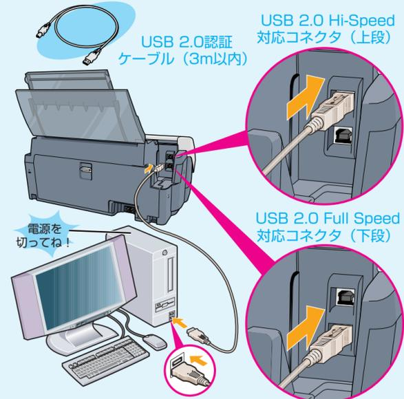
コンピュータがUSB 2.0 Hi-Speedに対応していない場合、またはコンピュータの環境を確認することができない場合は、下のコネクタ（USB 2.0 Full Speed）に接続してください。
