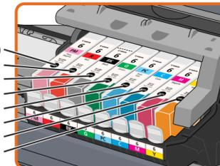
最初に取り付けるインクタンクは必ず同梱のものをご使用ください。古いタンクを使うと故障の原因となります。
