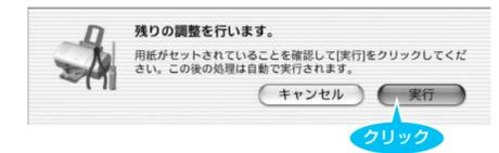
もう一枚のパターンが印刷され、自動でヘッド位置が調整されます。
