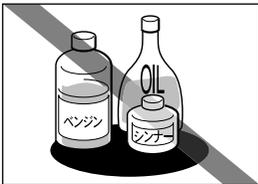
引火性溶剤が内部の電気部品に触れると火災や感電の原因になります。
