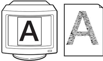
インクがなくなっているか、プリントヘッドのノズルの目づまりや、プリントヘッドの消耗が考えられます。以下の順番でメンテナンスを行ってください。必要なメンテナンスの操作については記載ページを参照してください。
