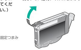
③図のようにインクタンクの底部をささえて持ち、 オレンジ色の保護キャップを、矢印の方向にひ
