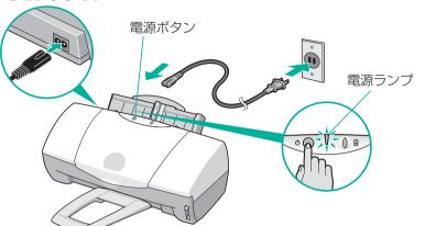
❸電源ボタンを押して電源を入れる。 電源ランプが点滅します。
