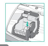
**6**同様にして、右から順にマゼンタ (BCI-3eM)、シアン(BCI-3eC)、 ブラック(BCI-3eBK)の インクタンクを取り付ける。
