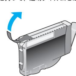
③ 図のようにインクタンクの底部をささえて持ち、オレンジ色の保護キャップを、矢印の方向にひねって取りはずす。
