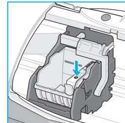
⑥ 同様にして、右から順にマゼンタ(BCI-3eM)、シアン(BCI-3eC)、ブラック(BCI-3eBK)のインクタンクを取り付ける。
