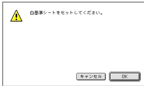
この場合は、白基準シートをセットして、[ OK ] ボタンをクリックしてください。白基準補正が行われます ( [白基準補正 P.62](#) )。
