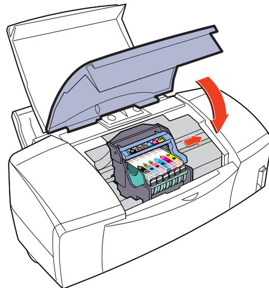
フロントカバーを 10 分以上開いたままにすると、プリントヘッドの乾燥を防ぐため、プリントヘッドホルダは右側へ移動します。フロントカバーをいったん閉じ、もう一度開いてみてください。
