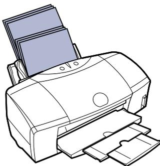
セットする前に、用紙をよくさばき、端を揃えてください。用紙をさばくことで、用紙と用紙の間にわずかに空気が入り、1枚ずつ確実に給紙することができます。
