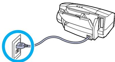
電源プラグがコンセントにしっかり接続されていることを確認します。電源プラグの挿入が浅いと、電源が入らないことがあります。
