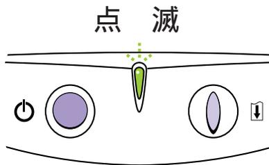
容量が大きい画像データを印刷すると、コンピュータがデータを処理したり、プリンタに印刷データを転送するまでに時間がかかります。このため、実際に印刷の途中でプリンタが止まっているように見えることがあります。
