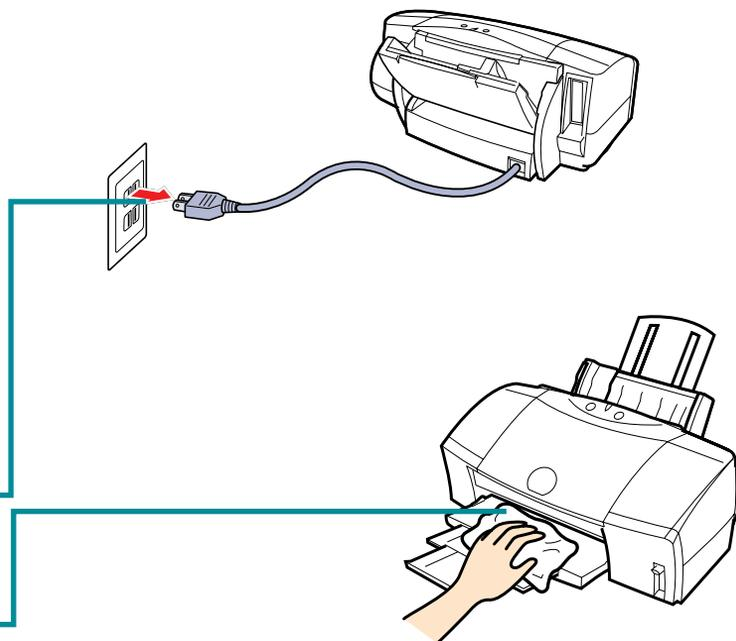
**警告** シンナー、ベンジン、アルコールなどの引火性溶剤を使わないでください。プリンタ内部の電気部品に接触すると、火災や感電の原因になることがあります。
