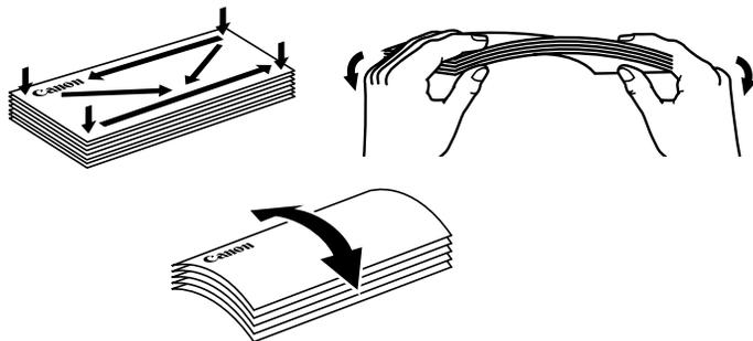
封筒をセットするときは、封筒の周りを押さえ、反りを取りながら封筒の中に入っている空気を抜いてください。反りがとれない場合は、封筒の端の対角を持って、反りと逆の方向に軽く曲げてください。
