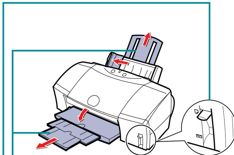
4 Tシャツ転写紙を袋から1枚取り出し、印刷面(緑の線がない面)を上にして、オートシートフィーダの右端に合わせてセットし、用紙ガイドをTシャツ転写紙の左端に軽く当てます。
