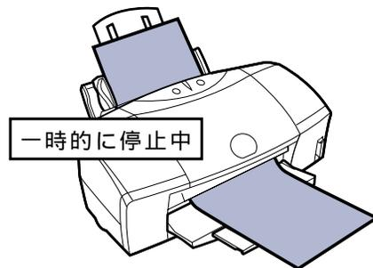
長い時間印刷を続けると、プリントヘッドが過熱します。プリントヘッドを保護するために、行の折り返し位置でプリンタが一時的に停止することがありますが、しばらくすると印刷が再開されます。区切りのよいところで印刷を中断して電源ボタンを押して電源を切ってから電源コードを抜き、プリントヘッドが冷えるまで、しばらくお待ちください(15分以上)。
