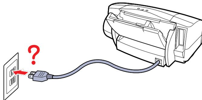
他の電化製品をこのコンセントに差し込み、電気がきているかを確認します。
