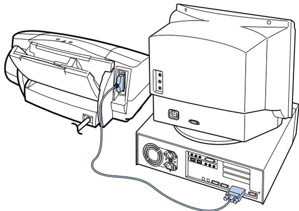
プリンタとコンピュータがしっかり接続されていないと、正しく印刷できません。よく確かめて、しっかり接続してください。
