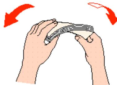
反ったはがきをセットすると、正しく給紙できないことがあります。反りと逆の方向にはがきを曲げ、反りを矯正してからセットしてください。
