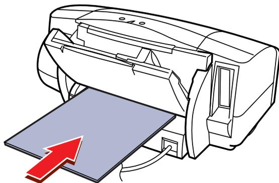
印刷したい面を上にして、手差し給紙口の左端に用紙を沿わせ、プリンタ内部に用紙が突き当たるところまでまっすぐに差し込んでください。1秒ほどで自動的に用紙が引き込まれます。
