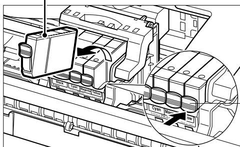
インクタンクの固定つまみを押して外します。
