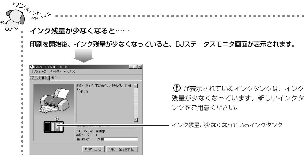
① が表示されているインクタンクは、インク残量が少なくなっています。新しいインクタンクをご用意ください。
