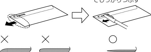
\* 上記の図は、封筒の挿入方向先端の断面図です
