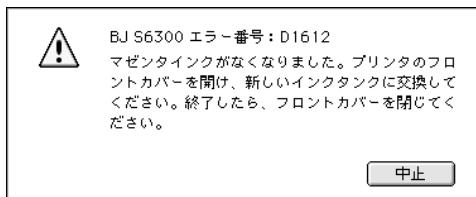
① インクを交換後、フロントカバーを閉じると、印刷を続行します (☞ p.44)。
