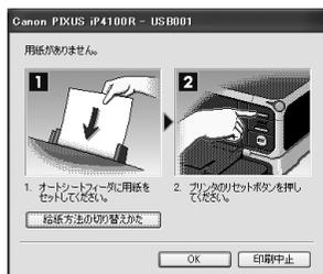
印刷中に用紙がなくなったり、紙づまりなどのトラブルが発生すると、自動的に BJ ステータスマニタが表示されます。BJ ステータスマニタが表示された場合には、[プリンタ情報] に表示されている対処方法にしたがって操作してください。
