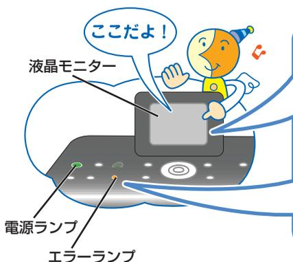
▶ 本プリンタでは、トラブルが発生した場合、エラーランプが点灯して、液晶モニターにエラーメッセージが表示されます。エラーメッセージの対処方法は、別冊『ダイレクトプリントガイド』の「困ったときには」をご覧ください。
