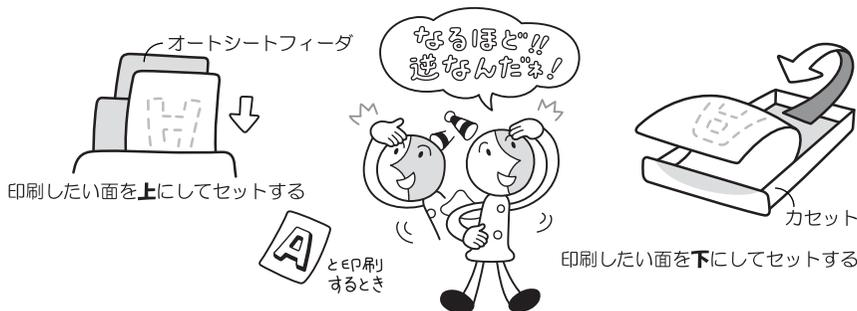
例えば、オートシートフィーダに専用紙、カセットに普通紙をセットすれば、用紙を入れ替える手間が省けます！
