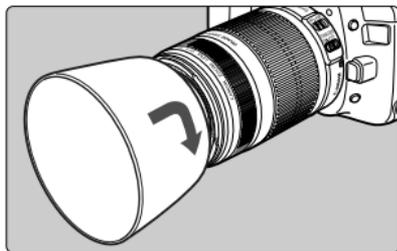
フードを矢印の方向に回して確実に取り付けてください。
