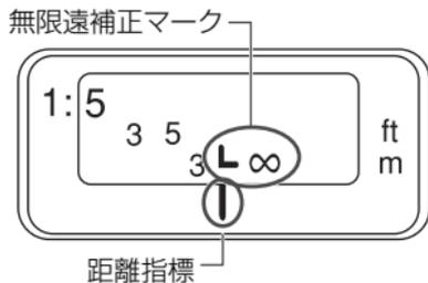
温度変化によるピント移動を補正するため、無限遠 (∞) 位置に余裕を持たせてあります。常温の無限遠位置は、Lマークの縦線と距離指標が合うところです。
