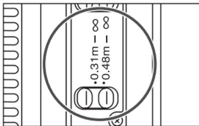
0.31m-∞または0.48m-∞の撮影距離範囲をスイッチで選べます。撮影距離に応じた設定にすることで、AF作動時間が短くなります。
