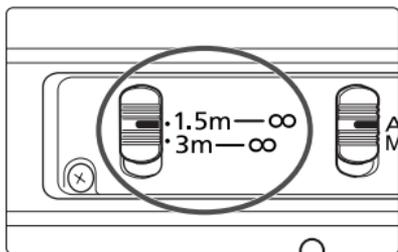
1.5m-∞または3m-∞の撮影距離範囲をスイッチで選べます。撮影距離に応じた設定にすることで、AF作動時間が短くなります。
