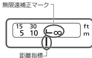
温度変化によるピント移動を補正するため、無限遠（∞）位置に余裕を持たせてあります。常温の無限遠位置は、Lマークの縦線と距離指標が合うところ です。
