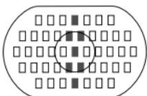
(1) F2.8 よりも明るい大口径レンズ使用時、■で示したAFフレームでは、十字測距（縦線横線同時検出）による高精度AF撮影が、残る38のAFフレームでは横線検出によるAF撮影ができます。
