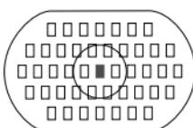
(2) 単体およびエクステンダーとの組み合わせでF4より明るい次のLタイプレンズでは、中央のAFフレームで十字測距による高精度AF撮影ができます。残る44のAFフレームでは横線検出のAF撮影（EF70-200mmF2.8L USM+エクステンダー EF1.4X除く）ができます。
