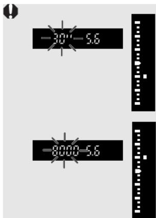
シャッター速度の「30」が点滅するときは、露出アンダー（露出不足）です。シャッター速度の点滅が止まるまで〈〉を回して絞り数値を小さくします（絞りを開く）。または、ISO感度を上げます。
