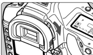
ファインダーから目を離してシャッターボタンを押すと、ファインダーから入った光によって露出が変わることがあります。そのようなときはアイピースシャッターレバーを矢印の方向に操作して、ファインダーを遮光します。
