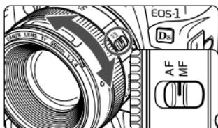
レンズのフォーカスモードスイッチを〈MF〉に切り換え、ファインダー内の被写体がはっきり見えるまで、レンズのフォーカスリングを回してピントを合わせます。
