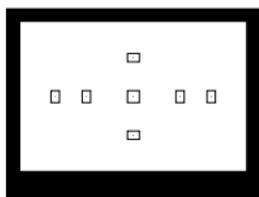
ファインダー内には、7つのAFフレームが配置されています。適切なAFフレームを任意に選択することにより、構図優先のAF撮影を行うことができます。また、被写体の状況や撮影意図にあわせてオートフォーカスの作動特性を選択できます。
