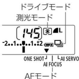
測光モードには、評価測光、部分測光、中央部重点平均測光があります。ドライブモードには、1枚撮影、連続撮影、セルフタイマー／リモコンがあります。撮影状況や撮影意図にあわせて選択してください。
