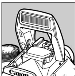
内蔵ストロボ、またはEOS用EXシリーズスピードライトを使用すると、E-TTL II自動調光（プリ発光・記憶式評価調光）により、ストロボなしの通常の撮影と同じ感覚で、自然で雰囲気のあるストロボ撮影を簡単に行うことができます。
