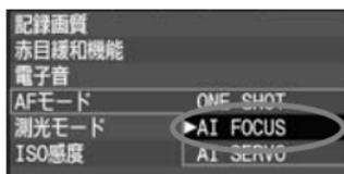
AIフォーカスAFは、被写体の状態に応じて、「ワンショットAF」から「AIサーボAF」へとカメラが作動特性を自動的に切り換えます。
