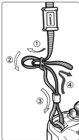
ストラップ（吊りひも）の取り付け方
