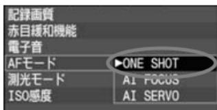
シャッターボタンを半押しするとAFが作動し、1回だけピントを合わせます
