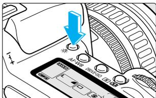
表示パネルには照明機能が付いています。<☀>ボタンを押すたびに照明が点いたり(☉6)消えたりします。暗い場所での撮影で表示パネルが見にくいときに使用してください。表示パネルの照明は撮影終了後、約2秒で自動的に消えます。バルブ撮影では、撮影開始と同時に表示パネルの照明は消えます。
