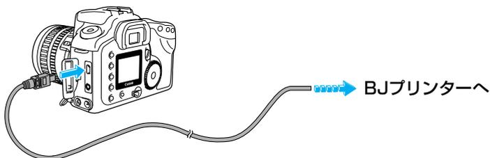
**1** 『カードフォトプリンターを接続する』(→119)の**1**～**3**と同じ手順で、カメラとプリンターを接続する
