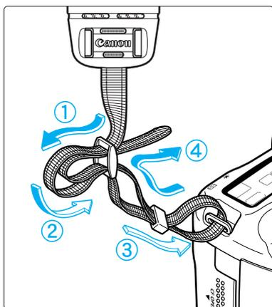
ストラップ(吊りひも)の取り付け方
