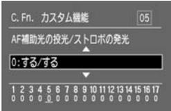
カメラのAF補助光、外部ストロボのAF補助光の投光を行うかどうか、また内蔵・外部ストロボの発光を行うかどうかを設定することができます。
