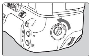
縦位置操作〈ON/OFF〉スイッチを〈ON〉にすると、縦位置撮影用のシャッターボタンなどが操作できるようになります。これらの撮影用操作部材は、WFT-E4に電池が入ってなくても操作できます。
