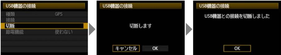
カメラとGPS機器の電源スイッチを切っても接続状態は解除されません。接続状態でUSB端子を抜いたときは、再度USB端子を接続し、上記の手順で接続状態を解除してください。
