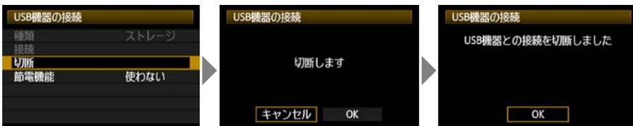
カメラと外部メディアの電源スイッチを切っても接続状態は解除されません。接続状態でUSB端子を抜いたときは、再度USB端子を接続し、上記の手順で接続状態を解除してください。
