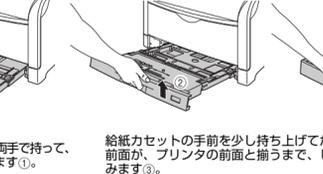
給紙カセットの手前を少し持ち上げてから②、給紙カセットの前面が、プリンタの前面と揃うまで、しっかりと奥まで押し込みます③。
