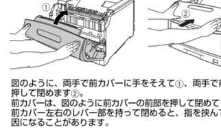
図のように、両手で前カバーに手をそえて①、両手で前カバーを押して閉めます②。前カバーは、図のように前カバーの前面を押して閉めてください。前カバー左右のレバー部を持って閉めると、指を挟んでけがの原因になることがあります。
