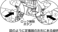
図のように定着器の左右にある緑色のロック解除ボタンを押しながら①、取っ手を持って定着器を手前に倒します②。
