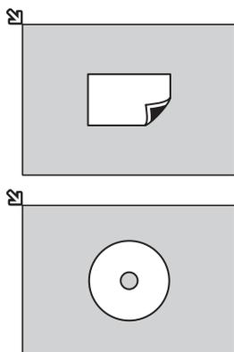
原稿台ガラスの端から10mm以上離し、読み取る面を下にして原稿を置いてください。
