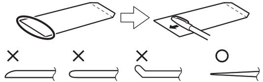
上の図は、封筒の先端部の断面図です。
