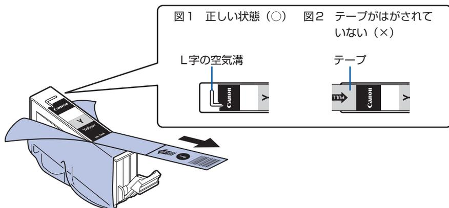
**チェック 4** ノズルチェックパターンを印刷し、必要に応じてプリントヘッドのクリーニングなどを行ってください
