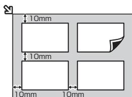
原稿台ガラスの端から10mm以上離し、読み取る面を下にして置いてください。原稿と原稿の間も10mm以上離してください。E判やL判は4枚、2L判やはがきは2枚までセットできます。
