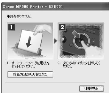
印刷中に用紙がなくなり、紙づまりなどのトラブルが発生すると、自動的にトラブルの対処方法を示すエラーメッセージが表示されます。この場合は、表示された対処方法にしたがって操作してください。
