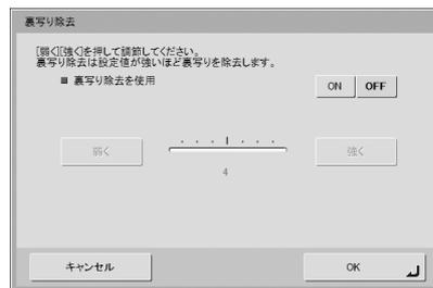
裏面に文字などがある薄い原稿をスキャンするときなど、裏面の模様が画像に写り込むようなときに、写り込んだ裏面の模様の画像を除去します。
