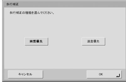
傾いた原稿の搬送をスキャンした画像で検知して、画像がまっすぐになるように補正します。
