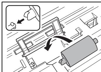
8. 固定レバーを矢印方向に動かし、フィードローラーの軸の穴に、はめ込みます。
