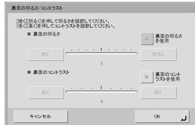
両面スキャンのときに有効になり、原稿の表裏の濃淡に差があるときに使用します。[裏面の明るさ（コントラスト）を使用] をチェックすると、原稿の表裏で明るさとコントラストの設定を変えることができます。
