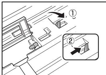
7. ローラーの軸の切り欠き部を本体の軸に合わせて、フィードローラーをセットします。
