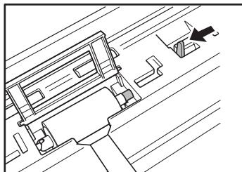
9. 固定レバーを倒してフィードローラーを固定します。
