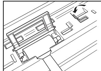
10. ローラーカバーを閉めます。カチッと音がしてカバーが元の位置に戻ったことを確認します。
