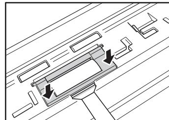
11. パネルユニットをゆっくり閉じます。そして、ユニットの両側を押し、カチッと音がしてロックされたことを確認します。
