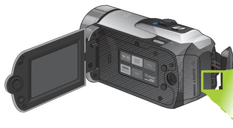
③ コンパクトパワーアダプターをビデオカメラのDC IN端子に接続
