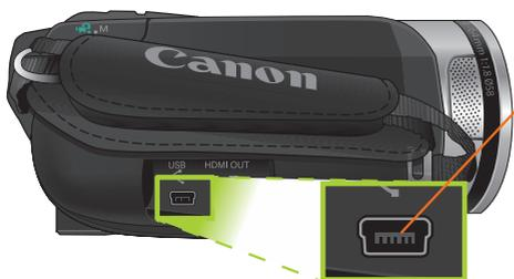
① ビデオカメラの USB 接続端子に USB ケーブルを接続
