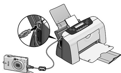
カメラとプリンタの接続が確認されると、操作パネルにデジタルカメラ接続中のアイコン が表示されます。
