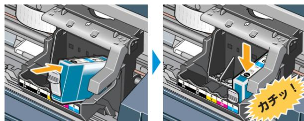
4 同じ手順 (1、2、3) で、他のインクタンクを取り付ける
