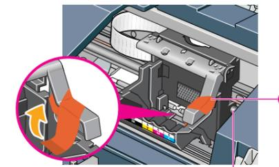
**禁止** ● レバーを除き、金属の棒などプリンタ内部には手を触れないでください。故障の原因になります。
