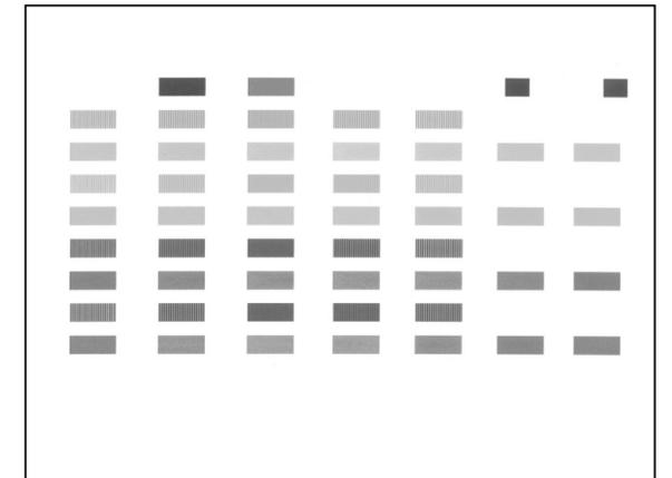
ヘッド位置調整が正常に完了したときには、上図のようなパターンが印刷されます。
