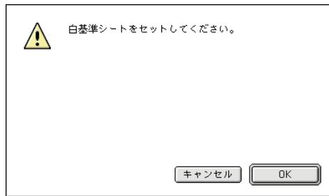
この場合は、白基準シートをセットして、[ OK ] ボタンをクリックしてください。白基準補正が行われます ( ➡ 白基準補正 P.63 )
