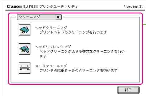
プリントヘッドのクリーニング、テストプリントなど、プリンタのメンテナンスをするための画面です。かすれて印刷されるときなどに開いて、プリントヘッドのクリーニングなどを行います。
