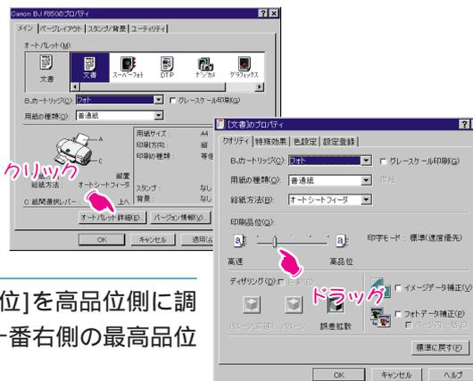
2. スライダーをドラッグして、[印刷品位]を高品位側に調整します。最高画質にしたい場合は、一番右側の最高品位に設定します。
