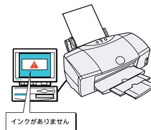
**参考** インクが完全になくなると、ブザーが鳴り、ランプがオレンジ色に点灯して印刷できなくなります。この場合は、インクタンクを交換してください。交換後、フロントカバーを閉じると自動的にプリントヘッドのクリーニングが始まります。ランプが点滅から点灯に変わったらインクタンクの交換は完了です。インクタンクの交換方法については、「インクタンクを交換する」(P.76)をご覧ください。
