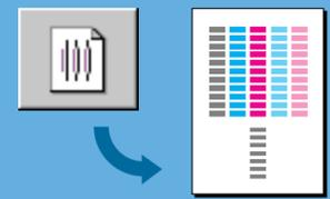
きれいに印刷をするためには、プリントヘッドの位置調整をする必要があります。プリントヘッドの位置がずれていると、きれいに印刷することができません。次の手順でヘッド位置調整パターンを印刷し、プリントヘッドの位置を調整しておきましょう。
