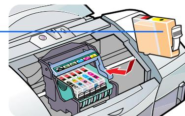
インクタンク上部の **PUSH** を押し、インクタンクを固定します。
