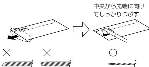
\* 上記の図は、封筒の挿入方向先端の断面図です
