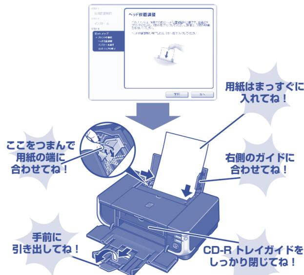
カセットからはプリントヘッドの位置調整はできません。必ず上図のようにオートシートフィーダへ用紙をセットしてください。
