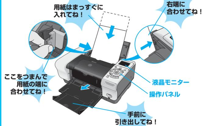
CD-Rトレイガイドが閉じていることを確認してください。以下は、操作パネルと液晶モニターを使って操作します。
