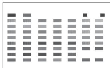
ヘッド位置調整が正常に完了したときには、上図のようなパターンが印刷されます。ヘッド位置調整が正しく行えなかったときには、液晶モニターに「自動ヘッド位置調整に失敗しました」のメッセージが表示されます(また、電源ランプがオレンジ色に11回点滅します)。このような場合は『ダイレクトプリントガイド』『プリントヘッド位置を調整する-自動調整』(P.73)を参照し、再度ヘッド位置調整を行ってください。
