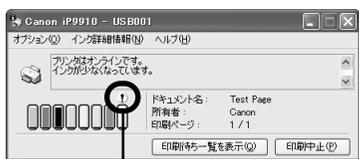
このプリンタは、2段階でインクの残量を確認できます。インク残量が少なくなると、印刷を開始したときに上記のメッセージ（インクがなくなりました）が表示される前に、BJ ステータスマニタ画面が表示されます。[!]が表示されているインクタンクは、インク残量が少なくなっています。新しいインクタンクをご用意ください。
