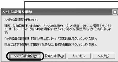
3 メッセージを確認して、[ヘッド位置調整] ボタンをクリックします。プリントヘッド位置調整パターンが印刷されます。印刷中はフロントカバーを開けないでください。
