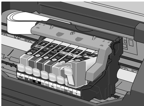
② インクタンク上面の(PUSH)の部分を押して、インクタンクを固定します。
