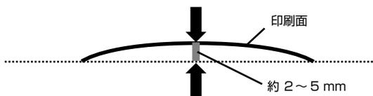
反りを修正した用紙は、1枚ずつセットして印刷することをお勧めします。
