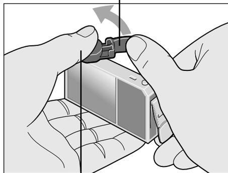
指にインクが付着しないように、キャップを抑えながら取り外します。
