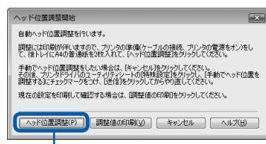
プリントヘッド位置調整パターンが印刷され、ヘッド位置が自動的に調整されます。印刷が終了するまでほかの操作を行わないでください。印刷が終了するまで約4分かかります。
