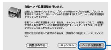
プリントヘッド位置調整パターンが印刷され、ヘッド位置が自動的に調整されます。印刷が終了するまではほかの操作を行わないでください。印刷が終了するまでに約4分かかります。
