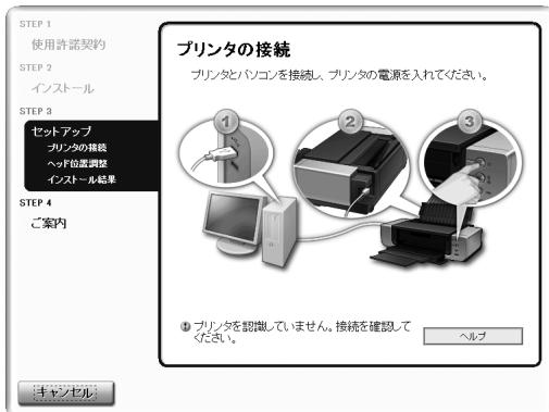
[プリンタの接続] 画面から先に進めなくなった場合は、本製品のUSBケーブル接続部とパソコンがUSBケーブルでしっかりと接続されていることを確認し、次の手順に従ってインストールをやり直してください。
