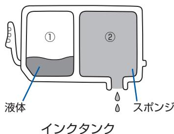
まず①がなくなると、インクランプがゆっくり点滅し、インクが少なくなったことをお知らせします。次に②がなくなると、インクランプの点滅がはやくなり、新しいインクタンクへの交換をお知らせします。
