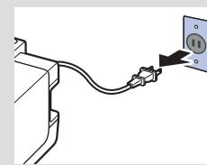
電源ボタンを押して電源を切ると、本製品は自動的にプリントヘッド（インクのふき出し口）にキャップをして乾燥を防ぐようになっています。ところが、電源ランプが消える前にコンセントから電源プラグを抜いたり、テーブルタップのスイッチを切ってしまうと、プリントヘッドが正しくキャップされずに乾燥や目づまりの原因となります。
