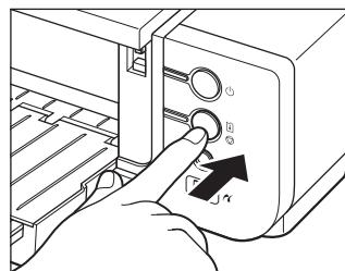
印刷中に電源ボタンを押してしまうと、パソコンから送られた印刷データなどが本製品にたまって印刷できなくなることがあります。
