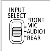
2チャンネル記録：AUDIO1のINPUT SELECTスイッチで選択します。
