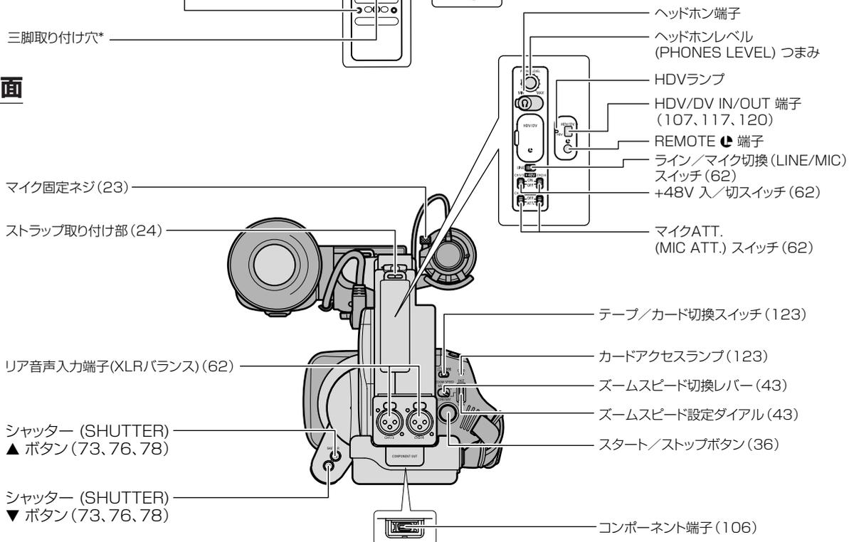
\*三脚は、必ず取り付けネジの長さが5.5mm未満のものをご使用ください。ネジ長が5.5mm以上の三脚を使用すると、本体を破損することがあります。
