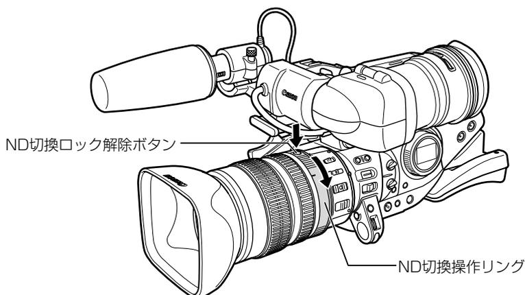
HD 20X L ISレンズの場合は、ND切換ロック解除ボタンを押しながら、ND切換操作リングを回します。撮影モードがマニュアル以外でゲインがA（オート）以外のときはNDフィルター警告表示が出ます。
