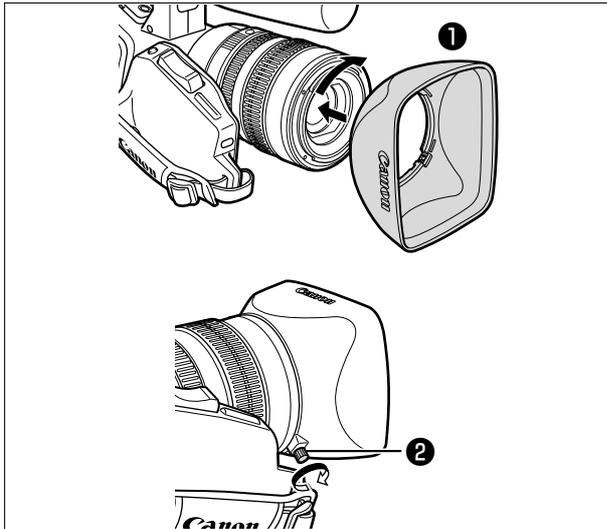
① レンズ先端部にフードをはめ込み、Canonの文字が上にくるように時計方向に回す
