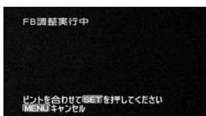
⑤ ズーム位置がテレ端になって、「FB調整実行中」画面で「ピントを合わせSETを押してください」が表示されたら、ピントを合わせ、SETボタンを押す
