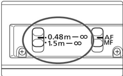
0.48m-∞または1.5m-∞の撮影距離範囲をスイッチで選べます。撮影距離に応じた設定にすることで、AF作動時間が短くなります。
