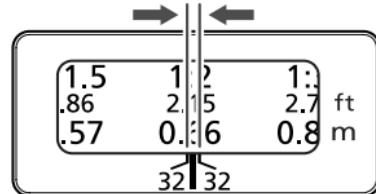
温度変化によるピント移動を補正するため、無限遠（∞）位置に余裕を持たせてあります。
