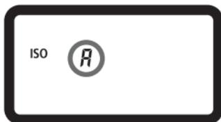
ISO感度の設定が「A」のときにシャッターボタンを半押しすると、実際に設定されるISO感度の数値が表示されます。ISO感度は、撮影モードに応じて次のように自動設定されます。
