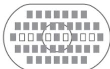
AFフレーム任意選択時は、■で示した39点のAFフレームで、より高精度なクロス測距（縦横線同時検出）を行うことができます。縦線検出は、横線検出の約2倍の敏感度で行われます。残りの6点では、横線検出によるAF撮影になります。
