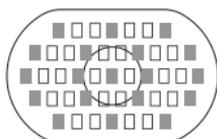
なお、AFフレーム自動選択時は、クロス測距点が39点から、■で示した19点に減少します。残りの26点では、横線検出によるAF撮影になります。
