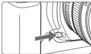
絞り込みボタンを押すと、そのとき設定されている絞り数値でレンズの絞り込みが行われ、ピントの合う前後方向の範囲（被写界深度）をファインダーで確認できます。
