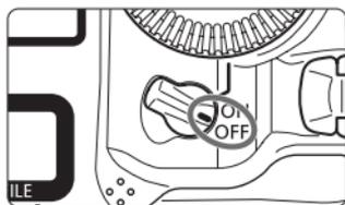
1 カメラの電源スイッチを〈OFF〉にする
