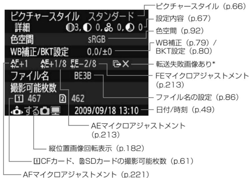
\* ワイヤレスファイルトランスミッター WFT-E2 II B、WFT-E2使用時に、転送失敗画像があるときのみ表示されます。
