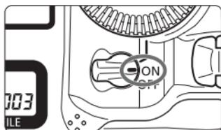
5 カメラの電源スイッチを〈ON〉にする
