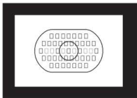
エリアAFフレーム内には、合計45点（39点：高精度クロス測距点+6点）のAFフレームが配置されています。45点の中から適切なAFフレームを選択することにより、構図優先のAF撮影を行うことができます。
