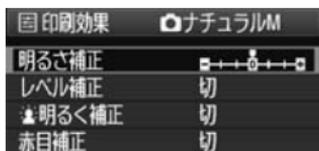
194 ページの手順 4 で項目を選び、**<INFO.>** の横に **<国>** が表示されているときに、**<INFO.>** ボタンを押すと、印刷効果の調整を行うことができます。調整できる（表示される）内容は、手順4の選択内容により異なります。
