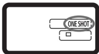
止まっている被写体の撮影に適しています。シャッターボタンを半押しすると1回だけピント合わせを行います。
