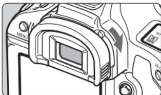
ファインダーをのぞかずに撮影すると、ファインダーから入った光の影響で暗い写真になることがあります。そのようなときは、アイピースシャッターレバーを矢印の方向に操作して、ファインダーを遮光します。
