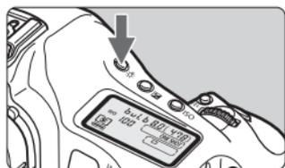
〈☀〉ボタンを押すたびに、上面/背面表示パネルの照明が点灯 (☀6) / 消灯します。
