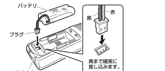
Ni-MH のリサイクルマークを上にしてバッテリを入れ、バッテリカバーを閉めます。
