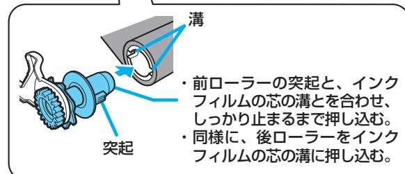
**3** 本体の前の溝にホルダーの前ローラーが入るよう両手で左右のつまみを持ち、インクフィルムを本体に取り付ける
