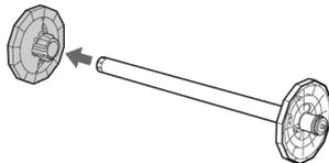
**3** ロール紙の先端を手前に向けて、ロール紙を左側から [ロールホルダー] に差し込みます。ロール紙は [ロールホルダー] のフランジ (a) に突き当たるまでしっかりと差し込みます。
