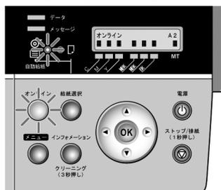
[ディスプレイ]に、[インクリョウ カクニン:xx] (xxはインク色)、[インクサンリョウ ナシ]、[インクタンク カクニン シテクダサイ:xx] (xxはインク色)、[インクタンク コウカン シテクダサイ:xx] (xxはインク色)、[オンラインキー オシテクダサイ インサツ カイシシマス]、[ヒツヨウ インクリョウ フソク]が表示されているときに、[インクタンク]を交換できます。
