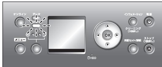
[データランプ]が点滅している場合は、印刷ジョブを受信中です。印刷が終了してから電源をオフにしてください。
