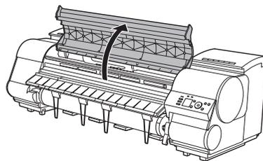
**2** [プラテン]上の[吸引口] (a)、[フチなし印刷インク受け溝] (b)、カッターガイド (c) に紙粉がたまっている場合は、プリンタに同梱されている[クリーナブラシ] (d) で掃き取ります。
