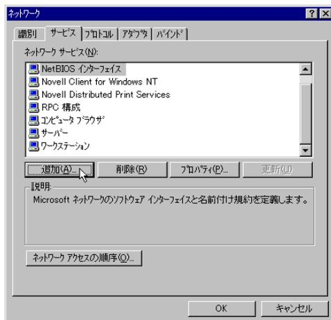
▼ [ ネットワーク サービス ] から [ Microsoft TCP/IP 印刷 ] を選択して [ OK ] ボタンを押します。
