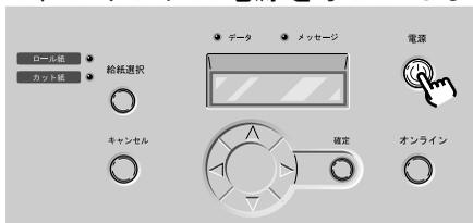
プリンタが起動した後ロール紙の給紙準備が始まり、完了すると印刷できる状態になります。
