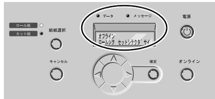
次の手順でロール紙を交換し、用紙の種類を選択して [確定] キーを押してください。
