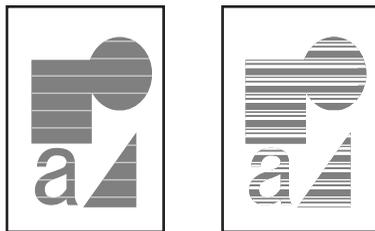
ノズルチェックプリントを印刷して、各ノズルがつまっていないかを確認します。印刷をする前に A3 横サイズ以上のロール紙またはカット紙をセットしてください。
