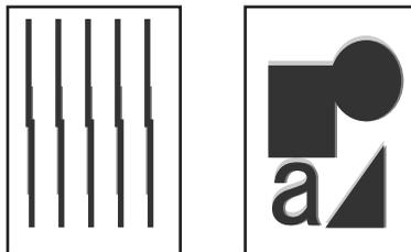
「パターン インサツ A」を印刷し、プリントヘッドの位置調整を行ってください。印刷をする前に A3 横サイズ以上のロール紙またはカット紙をセットしてください。
