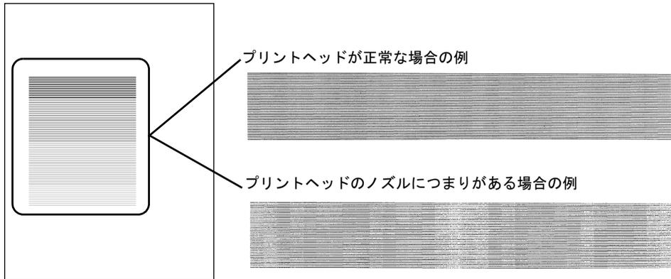
ノズルチェックパターンは、各色の横線に欠けやかすれがなければ、正常です。線が欠けている場合は、次の操作を行って再度確認してください。
