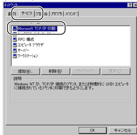
[Microsoft TCP/IP 印刷] がない場合は、[追加] ボタンを押し、[ネットワークサービス] の [Microsoft TCP/IP 印刷] を選択して、OS の CD-ROM からインストールしてください。
