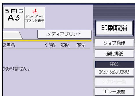
3. **確認するエラー履歴** を選択して、**【詳細表示】** を押します。
